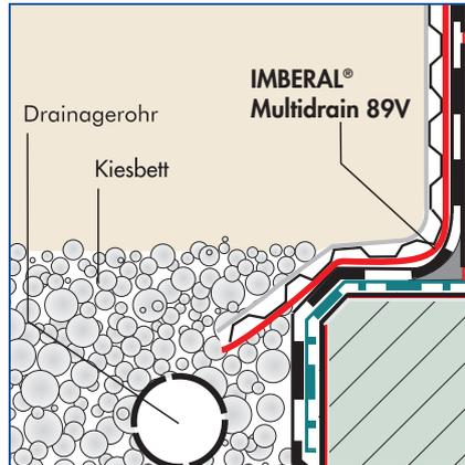
5 Unten endet die Bahn dicht am Drainagerohr in der Kiespackung.
